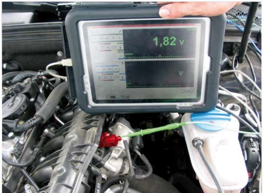
Messen der Ausgangsspannung am Saugrohrdrucksensor (hervorgehoben) im Audi A4 TFSI
